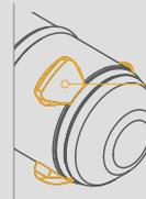
La distribuzione di forza uniforme dei poligoni riduce l'usura dei fori rispetto ai perni tradizionali. Il sistema di pressione conico raggiunge una superficie di appoggio notevolmente superiore.
